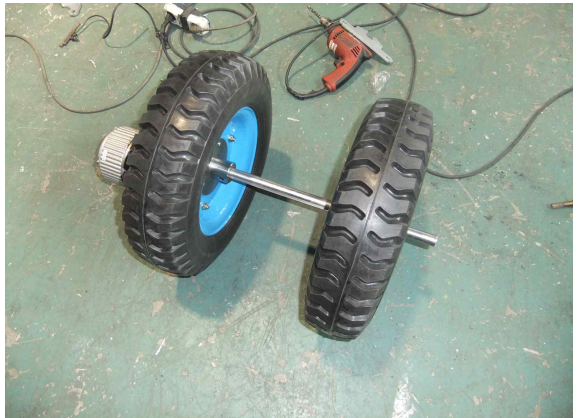
Fig. 3.3.5 직접구동식 모터와 본체 프레임 체결
