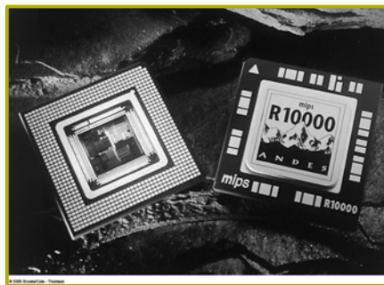
그림 12.35 64비트 마이크로 프로세서(R1000 RISC). 이 프로세서의 면적은 298\text{mm}^2 , 약 600만개의 트랜지스터를 가지고 있다.
